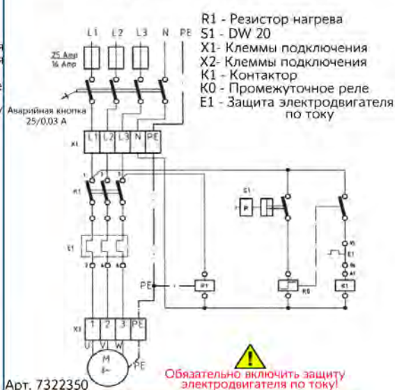
Схема подключения пневмоблока 230 /400 В для 1,1 кВт, 3~ с резистором нагрева
